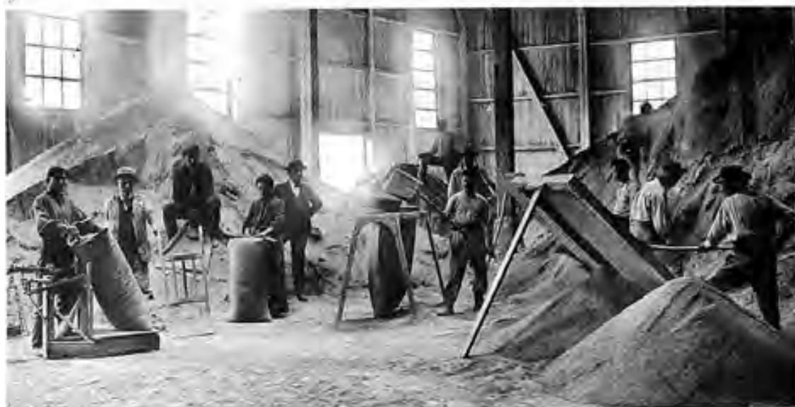
4. - Ensachage des superphosphates. (Coll. A. B. / H. B.)
